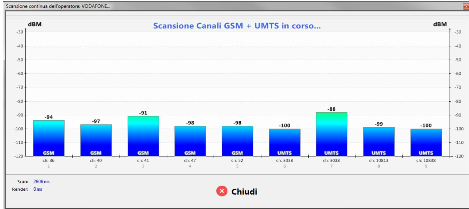
.....è inoltre disponibile una funzione avanzata per la scansione continua di un singolo operatore. Utile per effettuare il puntamento di antenne o identificare la zona di maggior copertura per l'installazione di combinatori GSM nei sistemi allarme.
