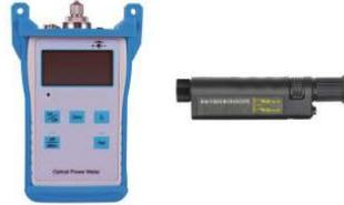
Per test di attenuazione utilizzare un Misuratore di Potenza Ottica e un microscopio per l'ispezione ottica.
