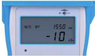
L'attenuazione in un punto di connessione della fibra ottica viene definito "punto di perdita" o IL (insertion loss).
