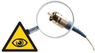
Ispezionare le ferule dei connettori prima della connessione con un microscopio. E' comunque raccomandata la pulizia preventiva della ferula.
