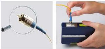
Per prestazioni ottimali, tutti i connettori devono essere controllati e puliti, se necessario, prima della connessione.
