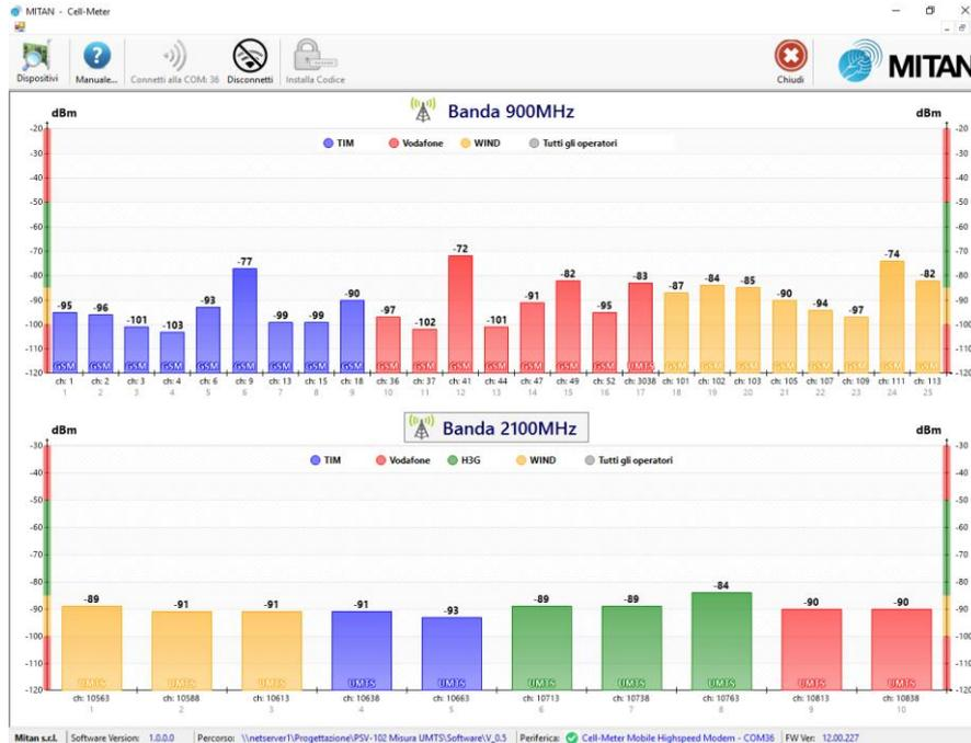
Posizionandosi con il mouse al di sopra di un canale (o con un click sullo stesso), vengono riassunte le principali caratteristiche del canale stesso, quali: il numero di canale, la tecnologia di trasmissione, la frequenza della portante, l'identificativo della Cella, l'identificativo dell'area, il codice MNC (Mobile Network Codes) dell'operatore e lo stato del canale.
