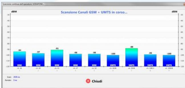
La funzione di scansione continua per singolo operatore è utile per il puntamento di antenne o identificare la zona di maggior copertura, utile, per esempio, per decidere dove installare il combinatore GSM nei sistemi allarme
